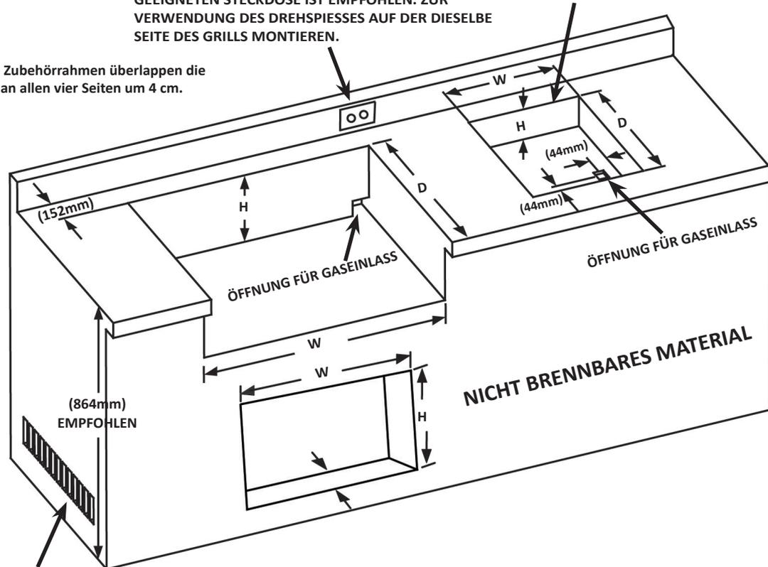
ZUR KORREKTEN BELÜFTUNG MUSS EIN MINDESTQUERSCHNITT VON 65 cm<sup>2</sup> AN ALLEN SCHRANKENDEN EINGEHALTEN WERDEN.
